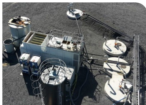
Kuvassa siirrettävällä Actiflo™-laitoksella puhdistetaan metallipitoisia kaivosvesiä.
